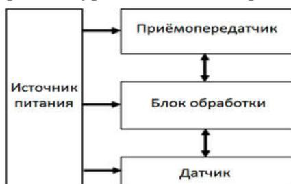
Рис.1. Аппаратная архитектура сенсорного узла
